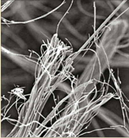
Amiante chrysotile (microscope électronique)
